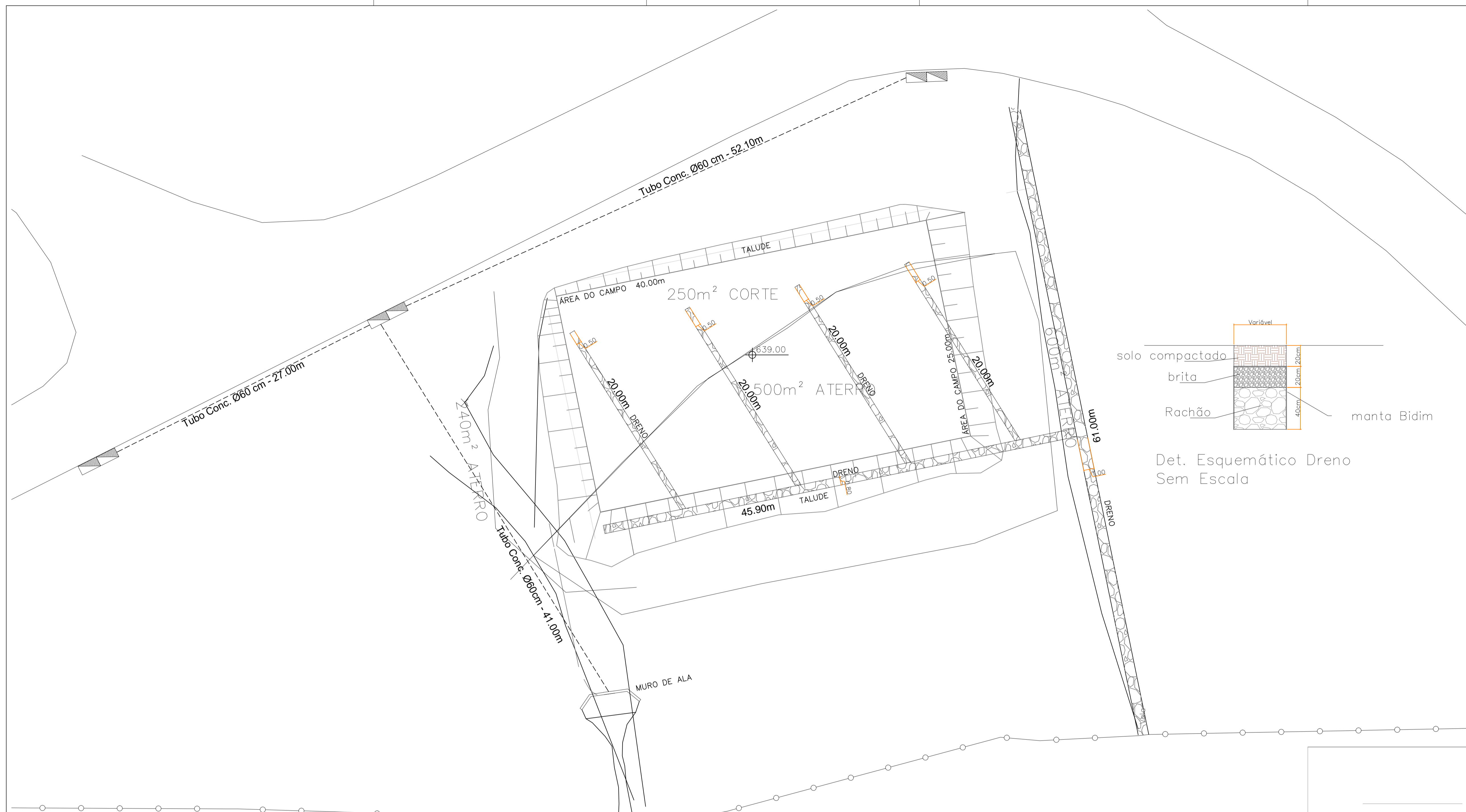
03 PLANTA BAIXA DO SISTEMA DE DRENO E GALERIAS PLUVIAIS ESCALA: 1:200
