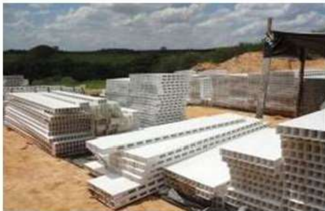
FIGURA 10 – Painéis de PVC pré-moldados na fábrica
