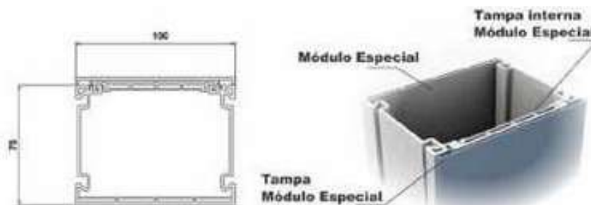
FIGURA 06 – Módulo especial usado para passagem de tubulações hidráulicas
