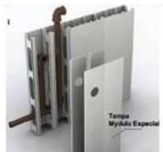
FIGURA 07 – Vista de uma parede com tubulação inserida nos módulos especiais
