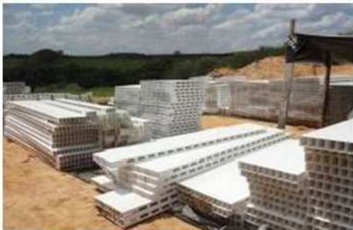
FIGURA 10 – Painéis de PVC pré-moldados na fábrica
