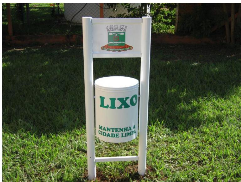
Lixeira metálica com 2 postes-lixo metálica tubular em aço carbono, composta por 02 tubos de 2" medindo 1,20m de altura por 0,35 de diâmetro; capacidade de 50 l, altura do coletor 0,55m, com cesto em chapa de aço carbono fechado, perfurado no fundo para escorrer água. Proteção anticorrosiva, com pintura eletrostática a pó na cor desejada pela administração. Adesivada com brasão da Prefeitura ou Art. escolhidos pela administração.
