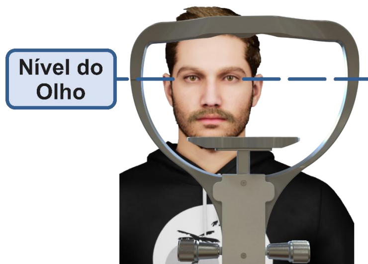
Figura 11 (c) : Ajuste a Altura da Queixeira para que a Altura do Olho
