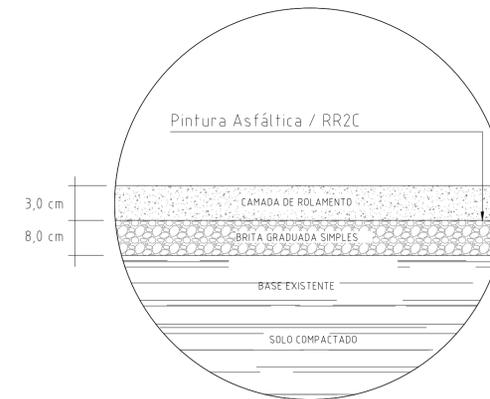
DETALHE PAVIMENTAÇÃO SOBRE BASE EXISTENTE
