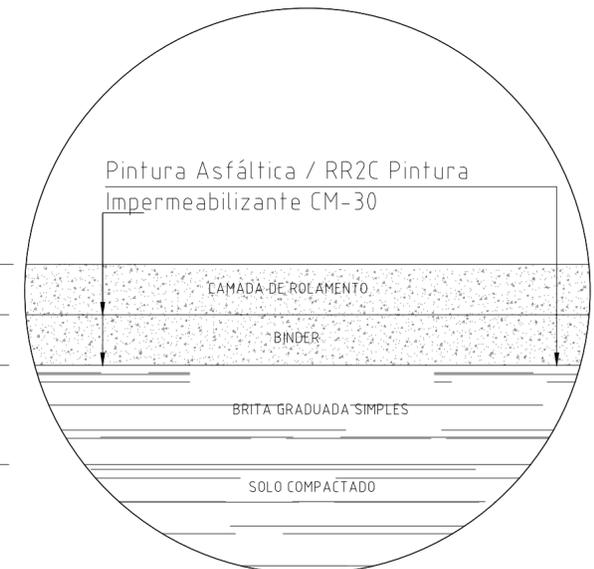
DETALHE PAVIMENTAÇÃO SITUÇÃO S/ESCALA
