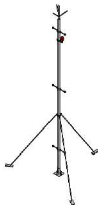
Figura 91 – Exemplo de Para Raio Tipo Franklin, 3 m, 1 Descida, 35°.
