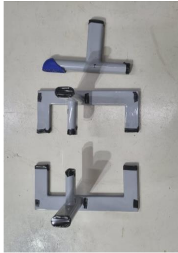
Foto 4 – Amostras com regiões de solda após 1600 horas em exposição
