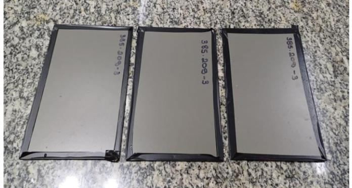
**Foto 3 – Amostras sem regiões de solda após exposição**
