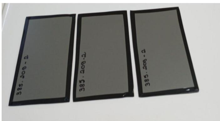
**Foto 2 – Amostras sem regiões de solda antes do ensaio**
