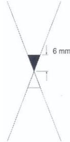
Y<sub>3</sub> – Destacamento acima de 4 mm até 6 mm em um ou em ambos os lados na intersecção
