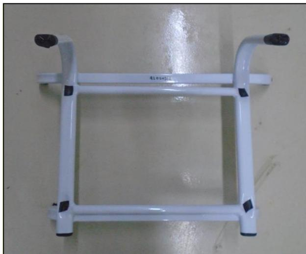
**Foto 7 – Cadeira seccionada antes do ensaio**
