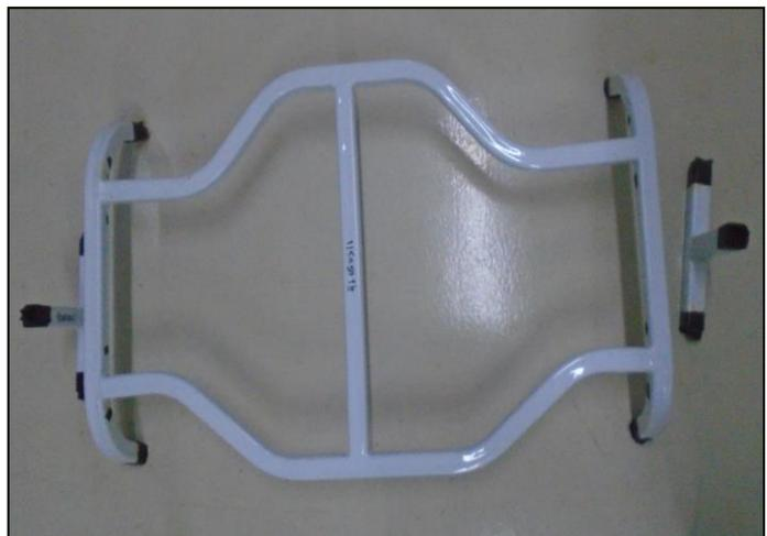
**Foto 6 – Mesa seccionada após o ensaio**
