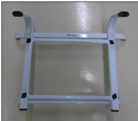
**Foto 8 – Cadeira seccionada após o ensaio**
