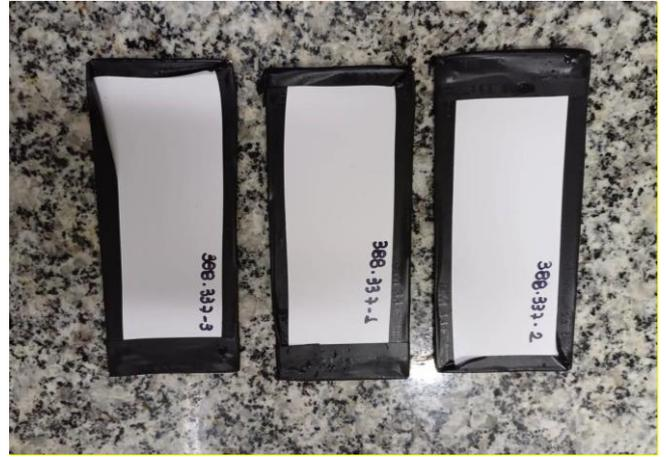
**Foto 3 – Amostras sem regiões de solda após 360 horas em exposição**
