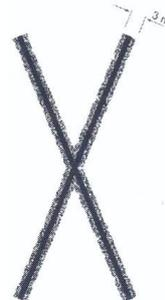
X<sub>3</sub> – Destacamento acima de 2 mm até 3 mm ao longo das incisões
