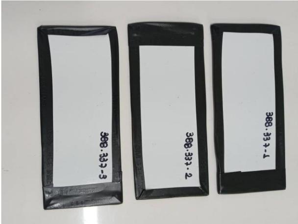
**Foto 2 – Amostras sem regiões de solda antes do ensaio**
