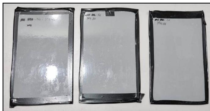
**Foto 3 – Chapas metálicas após 336 horas em exposição**
