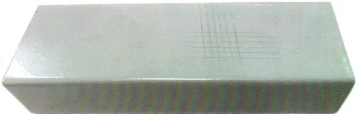
Amostra após teste de aderência. Observa-se que não ocorreu destacamento da pintura.
