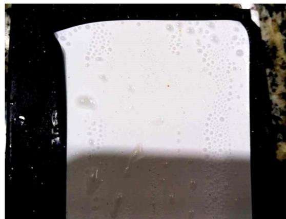
**Foto 3 – Amostras sem regiões de solda após 120 horas em exposição**
