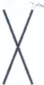
X<sub>2</sub> – Destacamento acima de 1 mm até 2 mm ao longo das incisões
