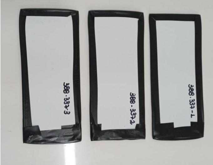
**Foto 2 – Amostras sem regiões de solda antes do ensaio**
