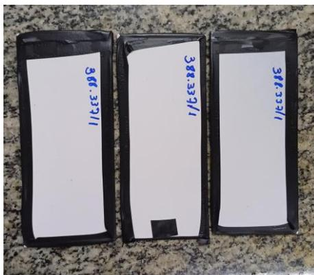
**Foto 2 – Amostras sem regiões de solda antes do ensaio**
