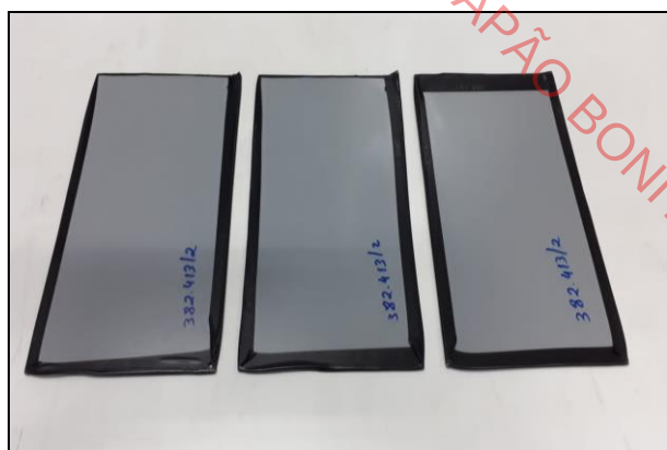
Foto 2 – Amostra sem regiões de solda antes do ensaio
