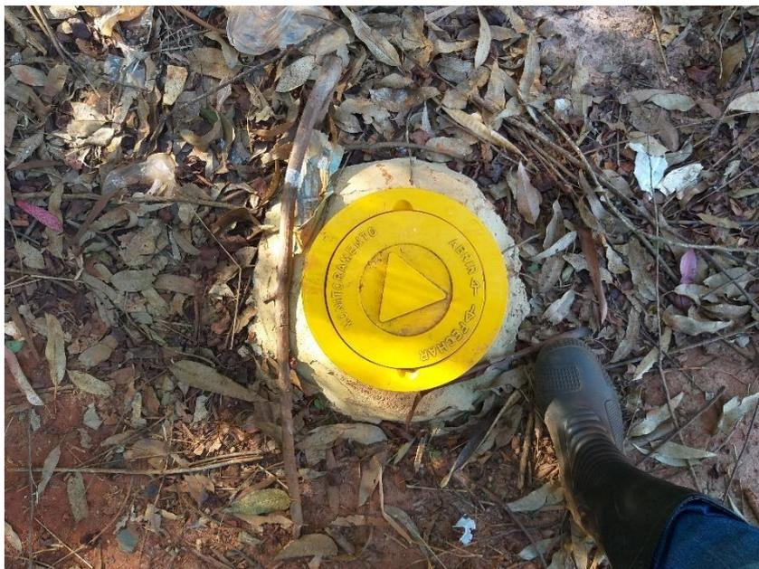
*Figura 13: Poço de monitoramento do Aterro Sanitário de Capão Bonito*
