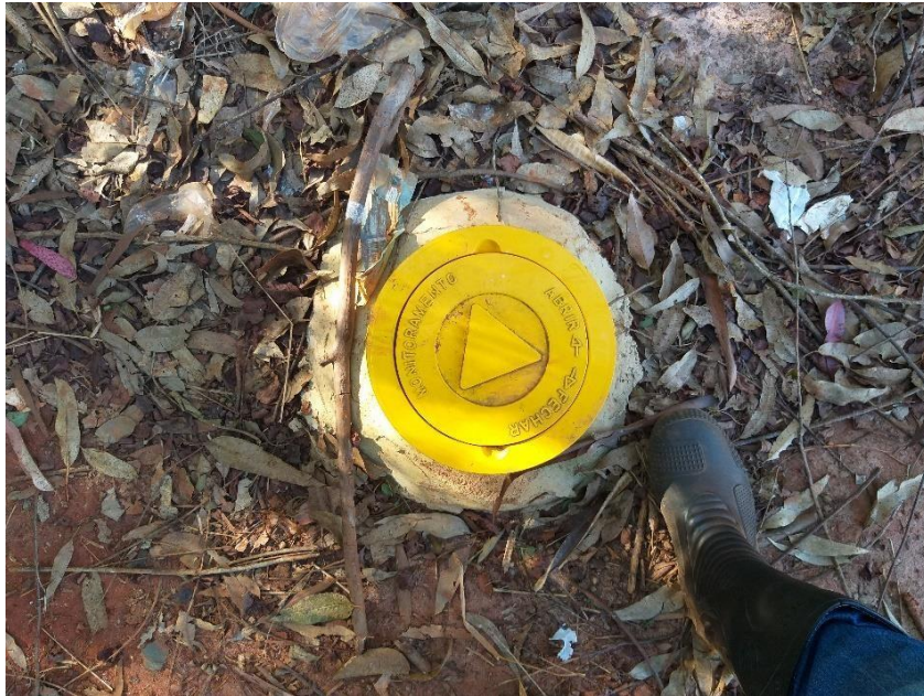
Figura 12: Poço de monitoramento do Aterro Sanitário de Capão Bonito.
