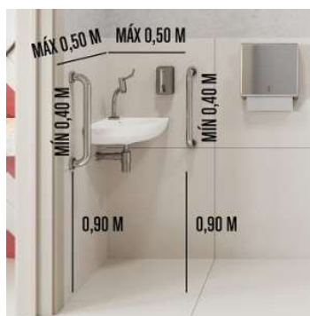
Figura 3: Medidas da instalação
