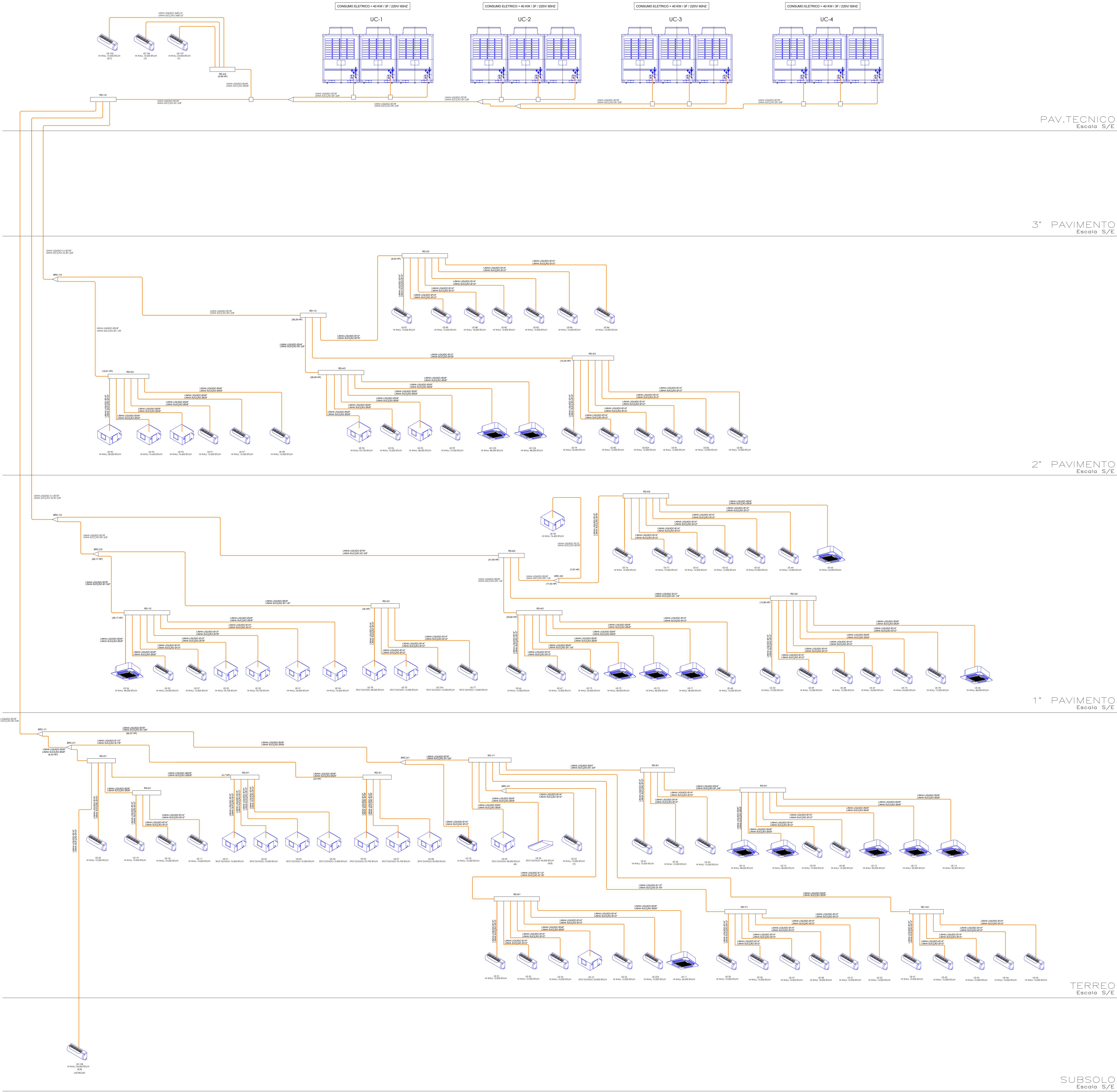
DIAGRAMA FRIGORIFICA VRF Escala S/E
